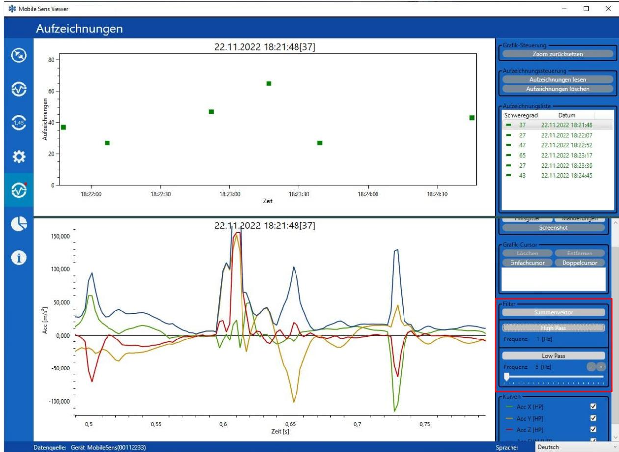
Als zusätzliche Werkzeuge verfügt der *Mobile Sens Viewer* über Filterfunktionen sowie über die Möglichkeit, einen Summenvektor aus den 3 Achsen zu berechnen und darzustellen.
